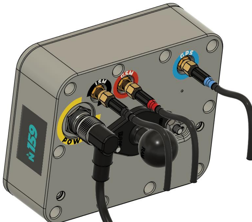
5. Ábra: Kábelek bekötése
