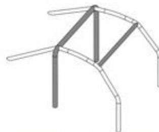
1 főbukócső 2 oldalsó félbukócső 1 keresztirányú merevítő 2 hátsó megtámasztás
