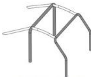
1 főbukócső 1 mellő bukócső 2 hosszanti merevítő 2 hátsó megtámasztás
